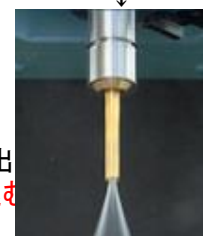
PSリング装着後 (※パーフェクトシール) …しかしPSリングがZC溝に 食い込んでしまうので外す
