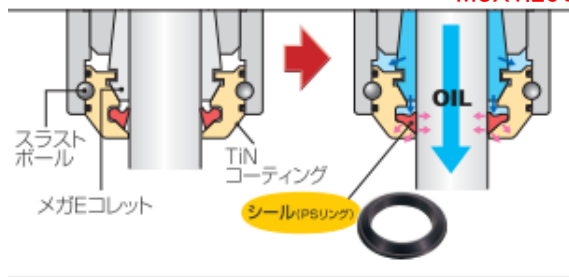
【大昭和精機・FONBCコレット】 ⇒推奨 このスリットは途中で止まっている 【注意】コレットの把握範囲は0.1mm ⇒M8X1.25のφ6.2が掴めない
