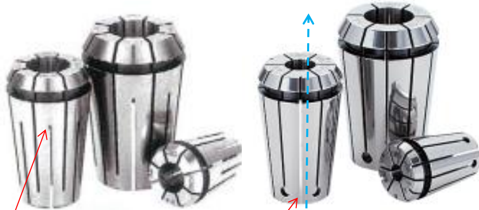
【大昭和精機・FONBCコレット】 ⇒推奨 このスリットは途中で止まっている 【注意】コレットの把握範囲は0.1mm ⇒M8X1.25のφ6.2が掴めない
